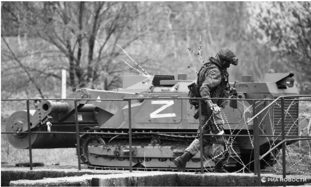
Рисунок 1. © РИА Новости / Алексей Майшев. Робототехнический комплекс разминирования "Уран-6" на территории теплостанции в Счастье, ЛНР.
